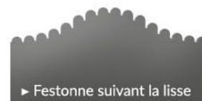
► Cache-vue en tôle aluminium avec peinture de finition (épaisseur 10/20), de 1m de large plaqué et riveté aux barreaux et entre 1 à 2m de hauteur
